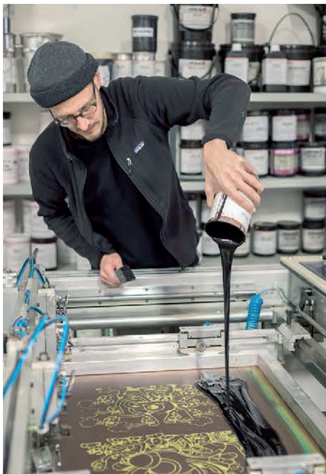
Monsieur Mottet verse l'encre sur le cadre avant de passer la racle pour imprimer un support.
